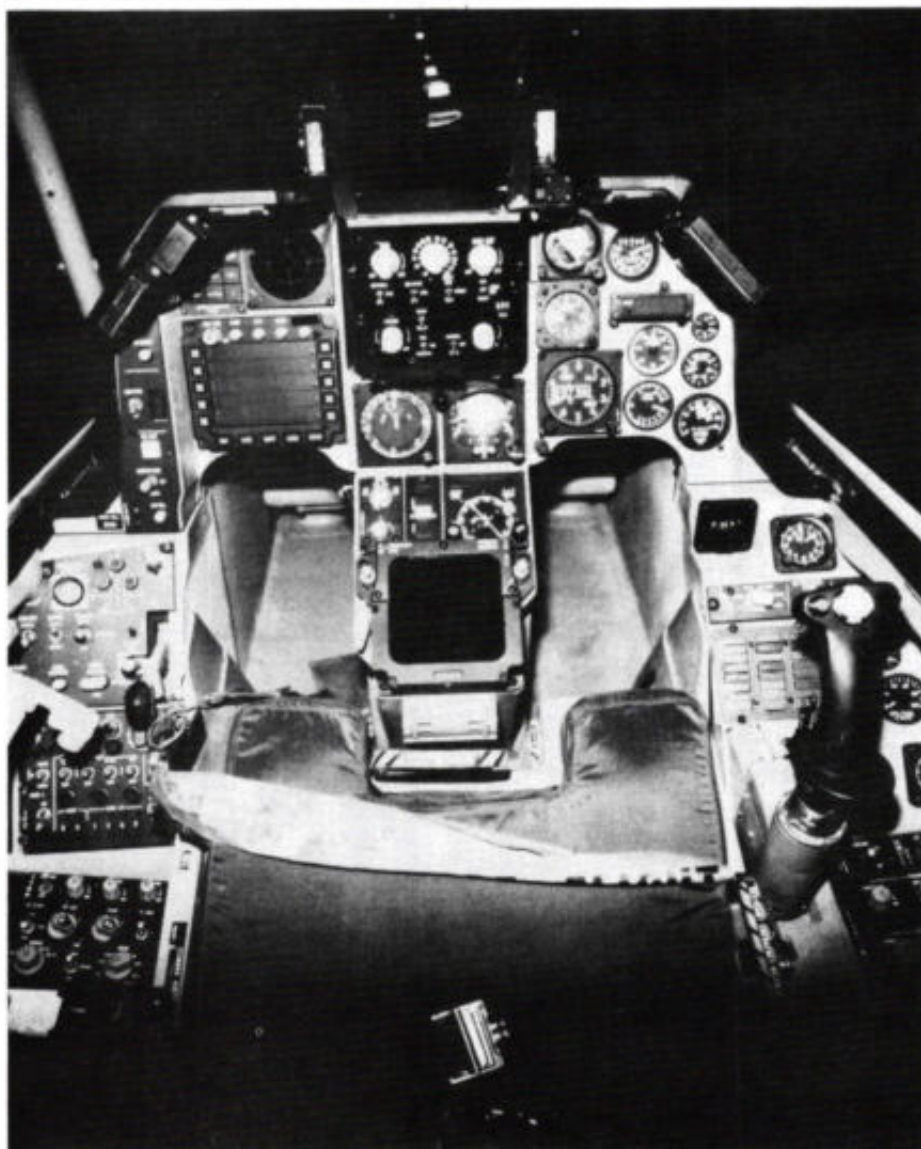
Afb. 5. De besturing van de F-16 van de Koninklijke Luchtmacht werkt volgens het 'fly by wire'-principe. Rechts van de stoel bevindt zich het „pietere pookje" (sidestick). De stuurcommando's van dit pookje worden via een computer gedoseerd en overgebracht naar de stuurvlakken (foto: Luchtmacht Voorlichtingsdienst).
