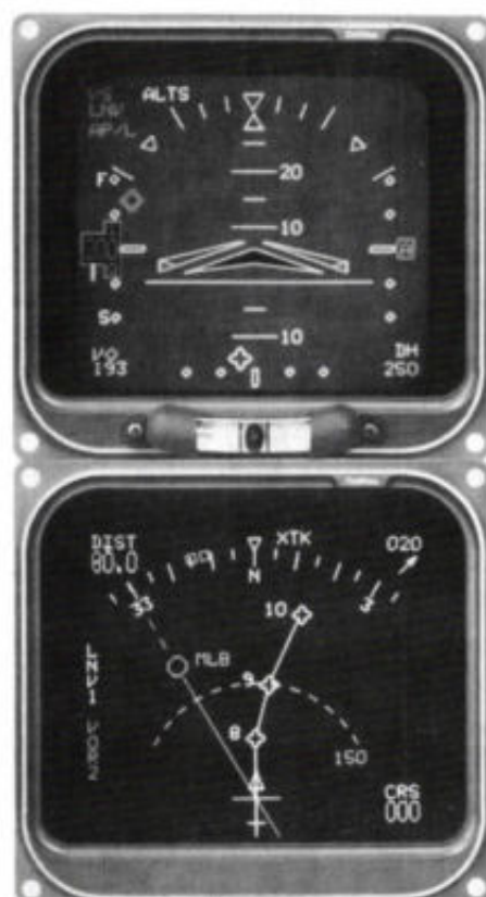
Afb. 2. Dubbele EFIS-beeldschermen van Collins, bedoeld voor kleine en middelgrote zaken-vliegtuigen van het type 'Super KingAir 200' en 'BAe 800'. Het bovenste beeldscherm is de elektronische ADI (Attitude Director Indicator) en combineert de presentatie van de vliegstand met de vliegsnelheid. Deze laatste parameter wordt in digitale vorm links op het beeldscherm in beeld gebracht. Het onderste beeldscherm geeft de koers aan en laat bovendien de te vliegen route langs een aantal referentiepunten zien, de zgn. 'way-points'. Dit beeldscherm wordt aangeduid als de elektronische HSI (Horizontal Situation Indicator).
