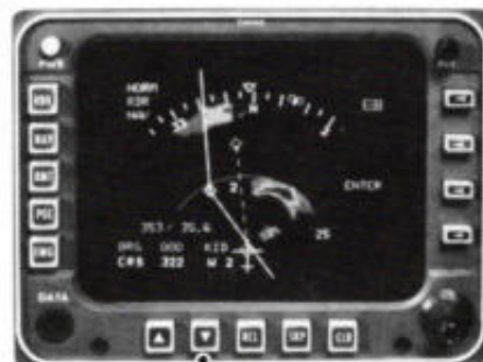
Afb. 4. Als integraal deel van het EFIS van Collins kunnen op het Multi Function Display ( MFD ) HSI-, radar- of navigatiegegevens, doch ook een „checklist” worden weergegeven. Op dit beeldscherm zijn diverse beelden uit te vergroten.
